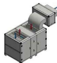
VERTICAL UVR-3/4/5/6 (con batería agua caliente/fría (70°/60°) (7°/12°))
