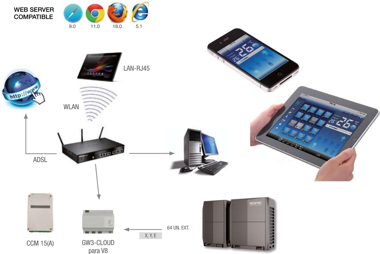
El software de monitorización central para los equipos KRV de Kosner dispone de una interface de usuario que permite realizar todas las funciones de configuración y control de una manera sencilla. El sistema **permite controlar hasta 64 unidades interiores**.
