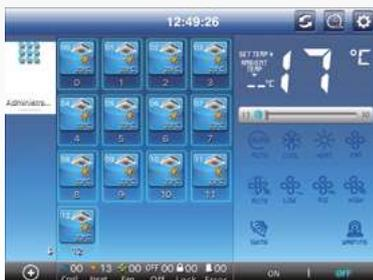
El sistema de monitorización central para KRV **permite visualizar los parámetros de funcionamiento** de cada una de las unidades interiores, acceder a los códigos de error o de protección y grabar parámetros de funcionamiento para realizar los mantenimientos de las diferentes unidades.
