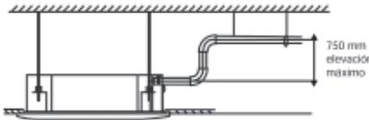
El cuerpo de la unidad interior extraplano hace que la instalación y el mantenimiento se realicen fácilmente: 2.8 kW~8.0kW:230 mm, 9.0 kW~11.2 kW:300 mm.
